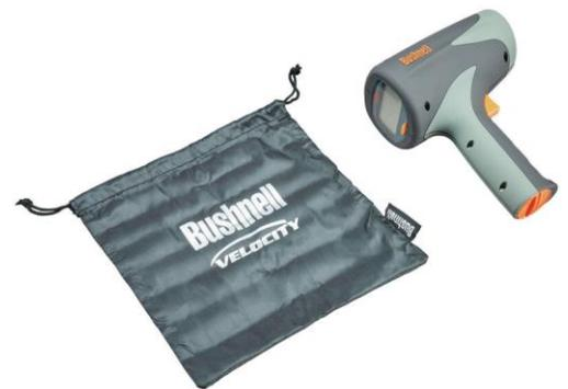
*Nota "Efecto Coseno": la precisión de la medición disminuirá a medida que aumenta el ángulo de medición entre el radar y el eje central del vehículo. La velocidad medida disminuye en la medida que la pistola se aleja del eje de movimiento.*
